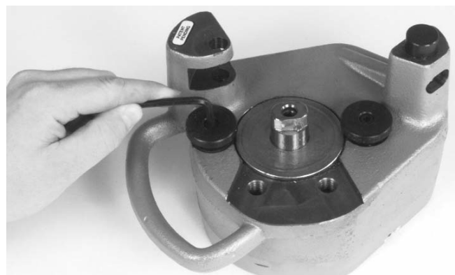
Obrázek 17 – Instalace měděné stabilizační podložky
